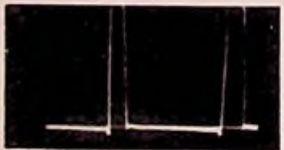
Bild 135. Unverzerrte Spannung an den Zeilenspulen
