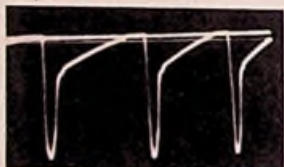
Bild 133. Oszillogramm der steuerebenen Spannung am Gitter der 6L6
