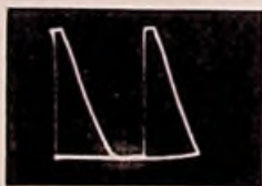
Bild 134. Anodenstromverlauf der 6L6 bei ohmschem Außenwiderstand
